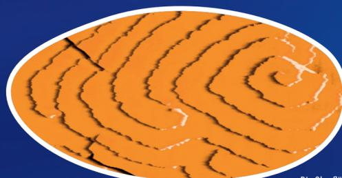
Die Oberfläche eines Proteinkristalls zeigt Fehler in der Stapelung der Schichten. Angesehen mit einem Rasterkraftmikroskop. © IUCr - Zeitschriften
