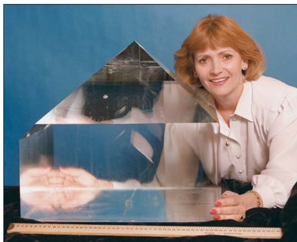
Кристалл Ge, выращенный из расплава методом Чохральского (слева) и кристалл \text{KN}_2\text{PO}_4 (KDP), выращенный из водного раствора (фото Н.П.Зайцевой).
