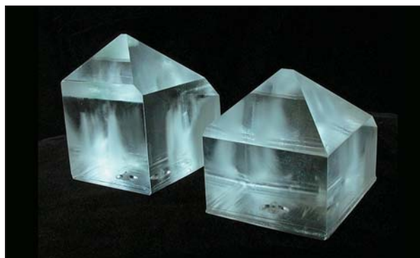
Кристаллы дигидрофосфата калия ( \text{KH}_2\text{PO}_4 , KDP), выращенные из водных растворов на точечной затравке методом снижения температуры.
