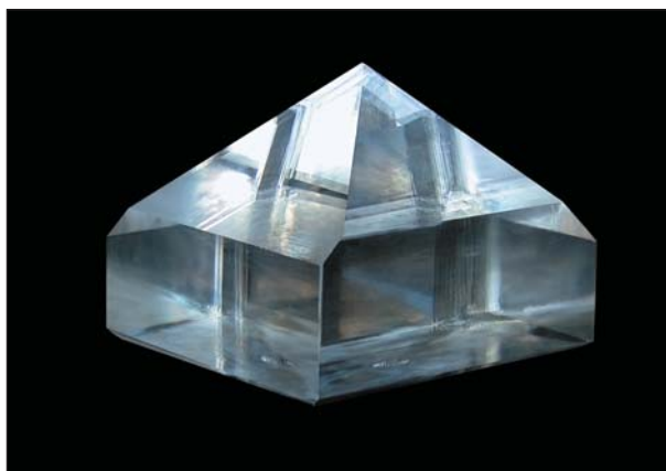
Кристалл дигидрофосфата калия ( \text{KH}_2\text{PO}_4 , KDP), выращенный из водного раствора на точечной затравке методом снижения температуры.
